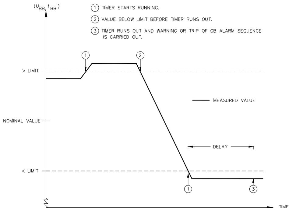
**Le jeu de barres/ jeu de barres d'alternateur attelé fonctionne suivant le principe de temps défini**
