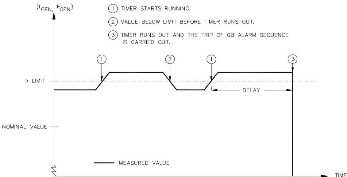
**Les fonctions de protection de générateur/ alternateur attelé se conforment au principe de temps défini.**
