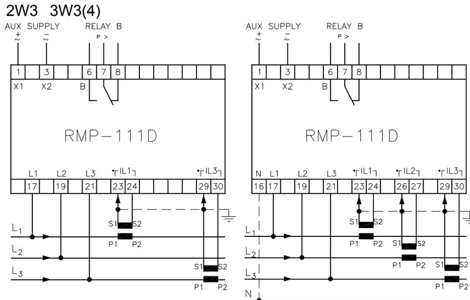
Der Hilfsspannungsanschluß kann durch eine 2A Sicherung geschützt werden.
