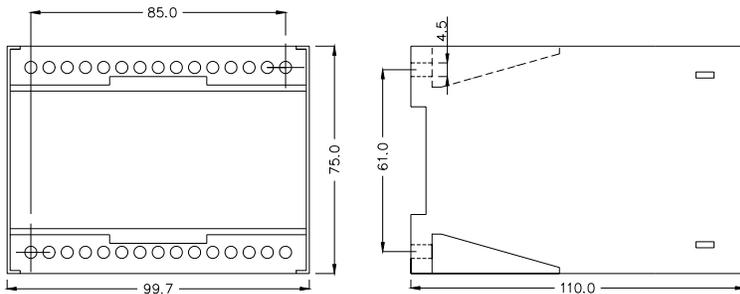
Das RMP-111D ist für den Schalttafelbau vorgesehen, entweder an einer 35 mm DIN Schienen oder mittels 2 Stück 4 mm-Schrauben.
