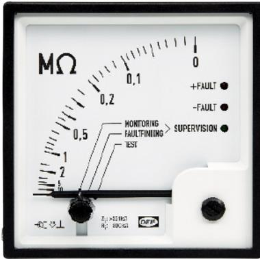
Los monitores de aislamiento SIM de DEIF supervisan la resistencia de aislamiento entre una red de distribución eléctrica aislada y un cable de tierra/seguridad. La avanzada secuencia de medida ejecuta un ajuste de compensación automática para eliminar posibles efectos de una capacitancia espúrea y tensiones de corriente continua (DC) desiguales.
