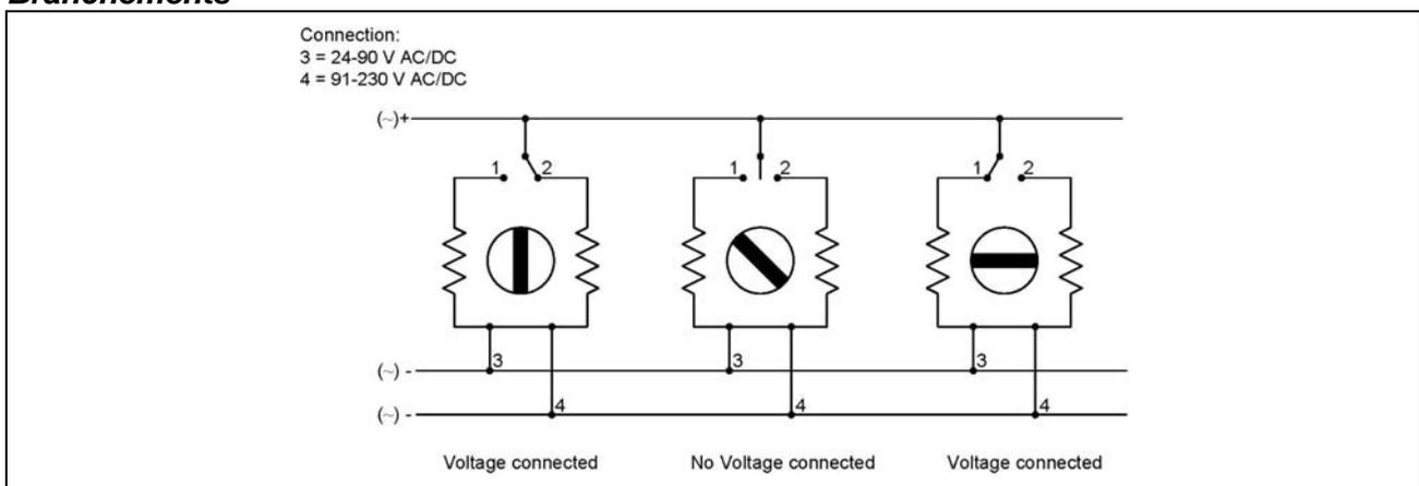
Note : Lorsque le PIR25 est utilisé avec une tension d'alimentation 91-230V AC/DC, aucun autre indicateur (voyant) ne peut être raccordé entre les bornes 1 + 4 et 2 + 4.
