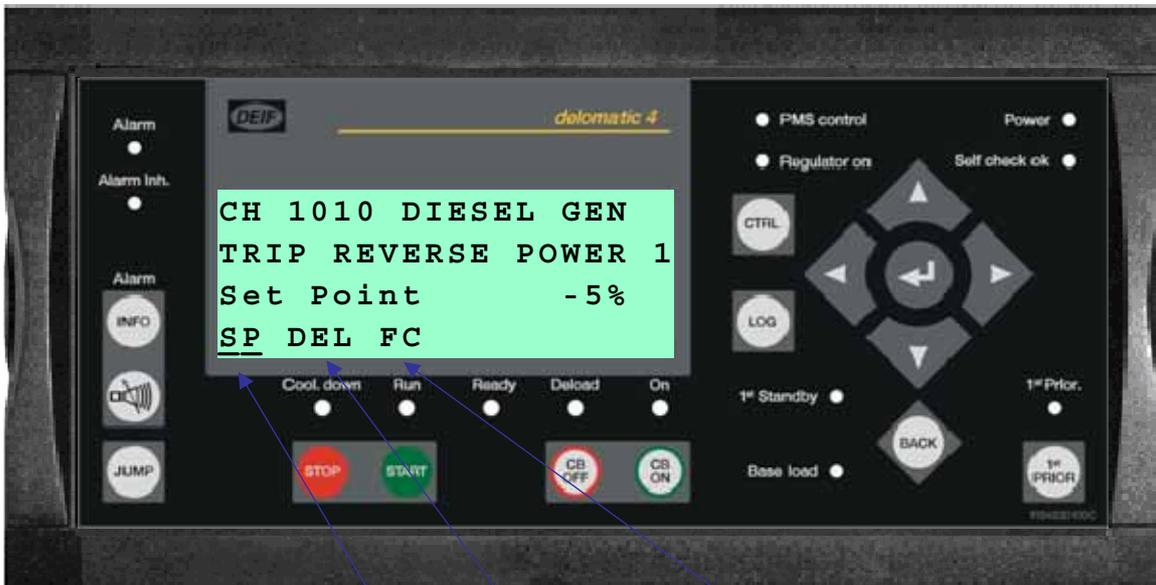
每个保护功能包括一个设定点 (SP)、定时器 (DEL) 和一个故障等级 (FC)，可以在规定的限值范围内对这些参数进行配置。所有参数均用密码进行保护，以防未经授权的人员更改设置。
