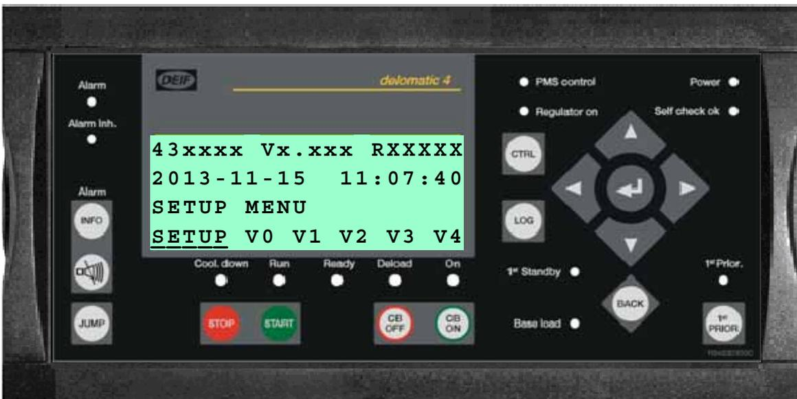
在上面窗口的第一行显示项目编号、软件版本和发布，第二行显示日期和时间，第三行显示 SETUP MENU 文本内容。在第四行，可以选择 SETUP 菜单或 V0-V4：
