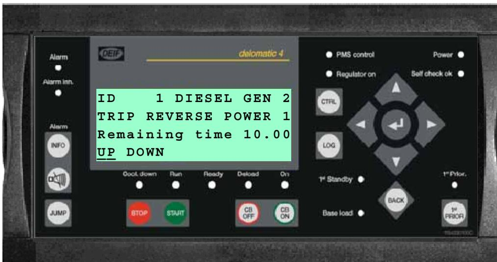
在选择输入、输出和模块 ID 之后，在显示面板上会显示每个输入/输出的状态。示例：
