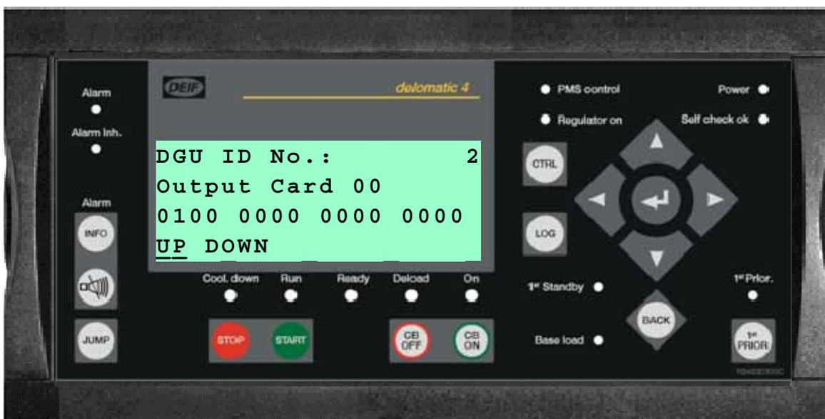
通道 0 的开关量输入显示在最左侧的第一位数字上。
