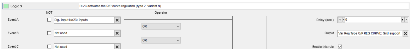
Abbildung 3.3 Beispiel für M-Logic zur Aktivierung einer Regelungsart
